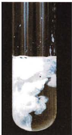
Silberchlorid-Niederschlag im Reagenzglas – eine typische Fällungsreaktion
