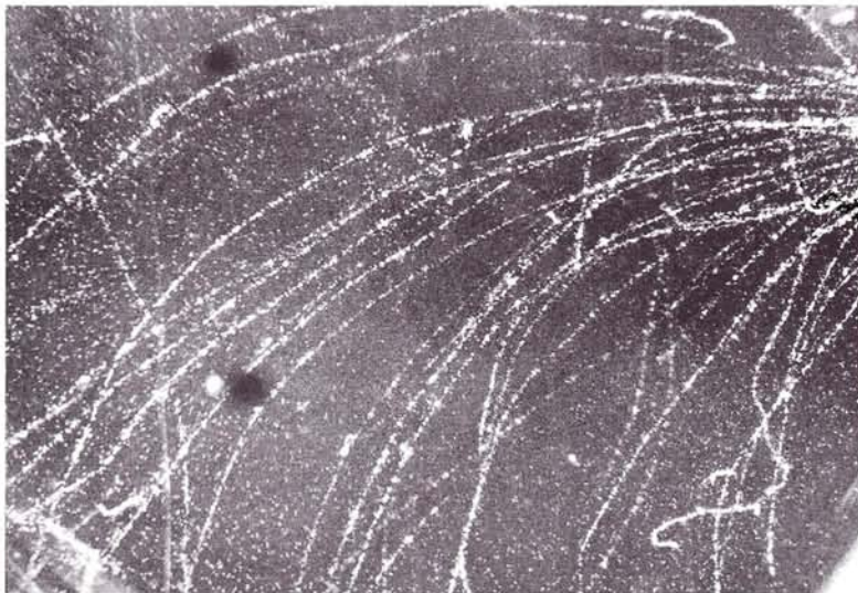
In England gebaute Nebelkammer aus dem Jahr 1911 (oben) sowie Kondensationsspuren von \beta -Strahlen einer natürlichen radioaktiven Quelle (unten)
