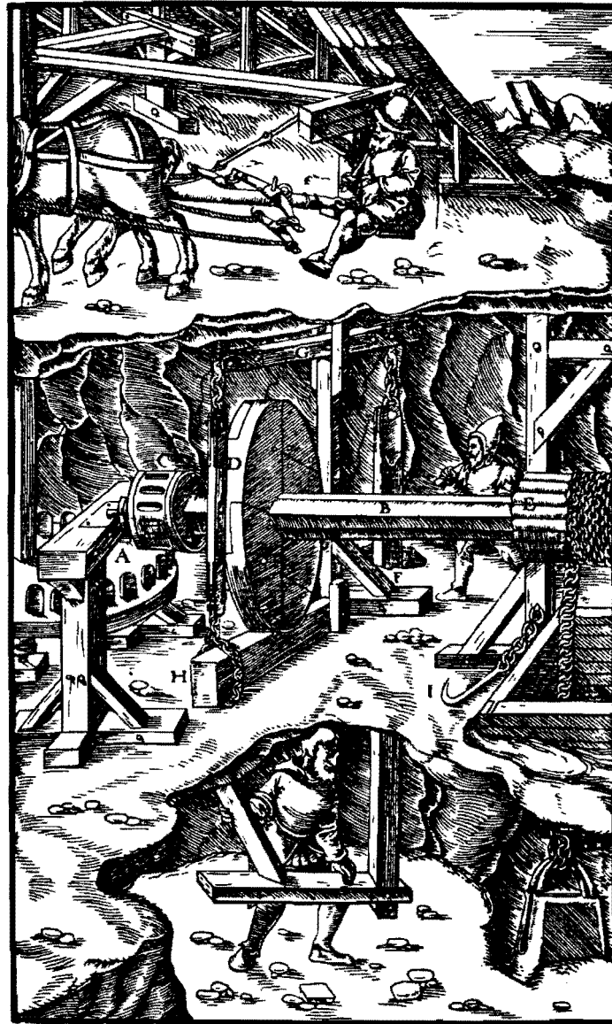
Das Kammrad an der stehenden Welle A. Die liegende Welle B. Das Getriebe C. Die Bremscheibe D. Der Seilkorb E. Der Bremschuh F. Der zweiarmige Hebel G. Der Bremsklotz H. Der Sturzhaken I.
