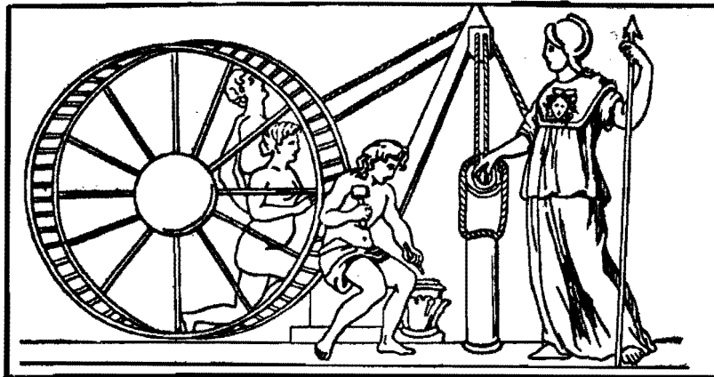
Römisches Hebezeug für Säulen. Antrieb durch ein Tretrad.
