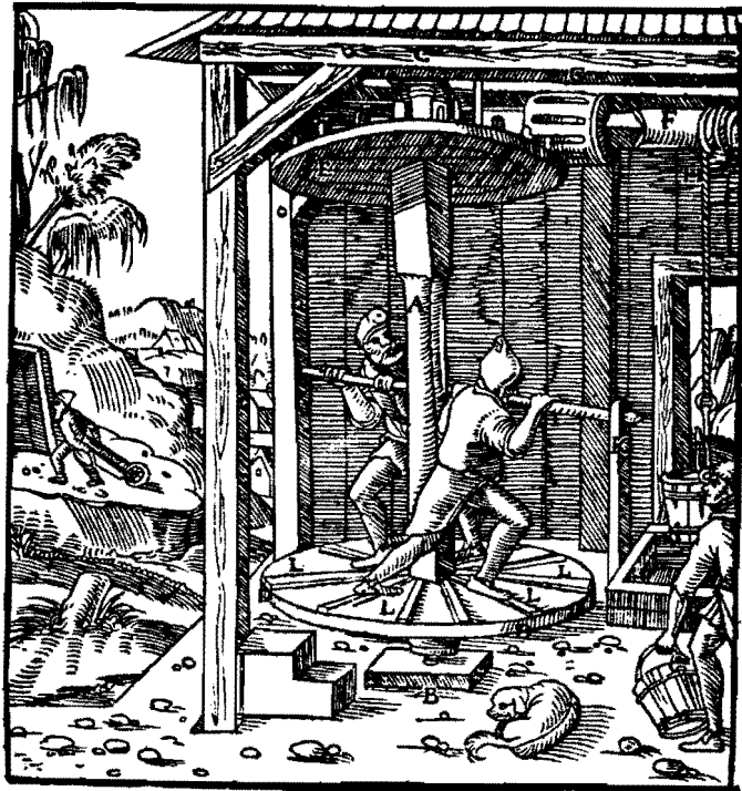
Die stehende Welle A. Der Klotz des Fußlagers B. Das Gebälk C. Die Scheibe D. Das Kammrad E. Die liegende Welle F. Das Getriebe G. Das Förderseil H. Die Stange I. Die Säulen K. Die Leisten der Scheibe L.
