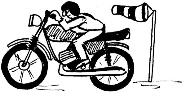
1. Der leichteste Mitschüler, der gut Moped fahren kann, durchfährt nach Erreichen der Höchstgeschwindigkeit die Meßstrecke mit dem Wind, wobei er eine möglichst flache (stromlinienförmige) Haltung einnimmt.
