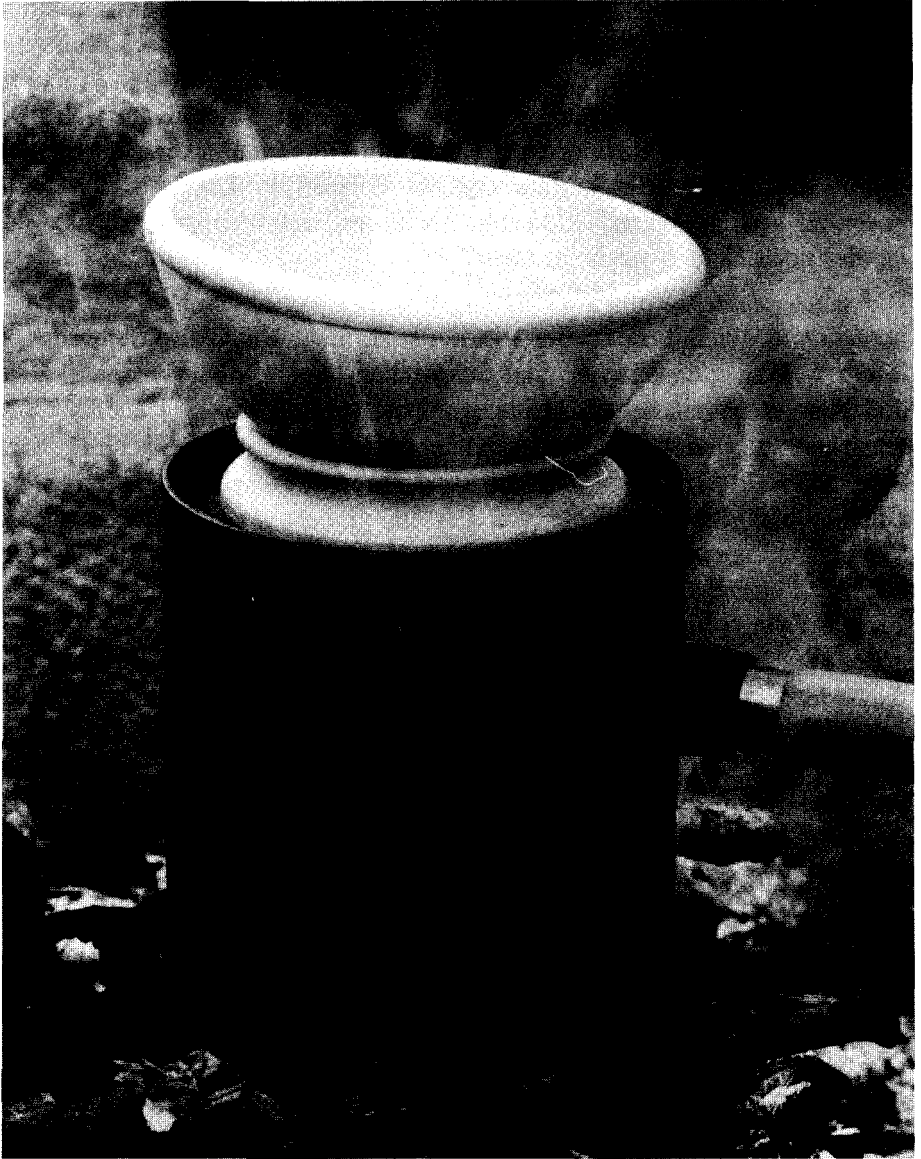
Gewinnung von etherischen Kräuterextrakten mit der transportablen Destillationsapparatur von M. Minssen
