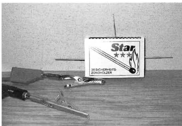
Abbildung 2: Einfache elektrische Black-Box als Low-cost-Version
